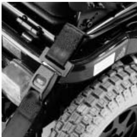
Abb. 7 Der SPRINT GT mit normgerechter Gurtgeometrie.
